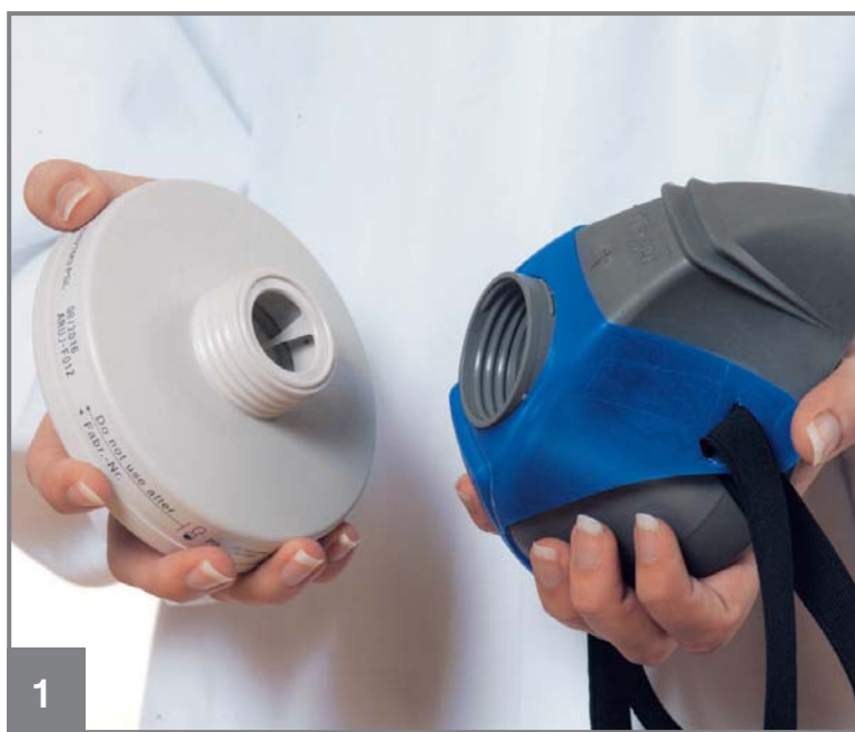
1 Anbringen des Dräger X-plore Filters mit Rd40-Gewinde (Standard-Anschluss nach EN 148-1).
